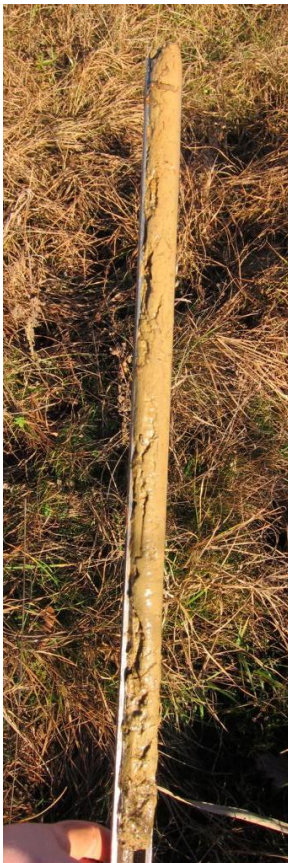
Abbildung 2: Haftwasser, im Bohrkern trocken und dicht
