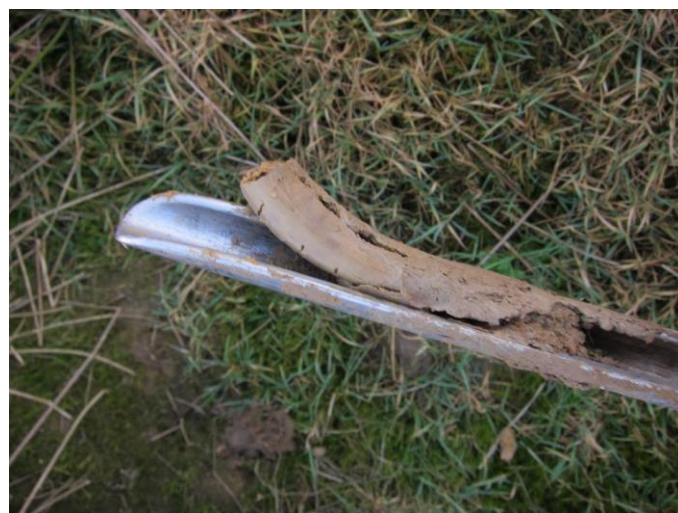
Abbildung 1: extrem verdichteter „Tümpelboden“
